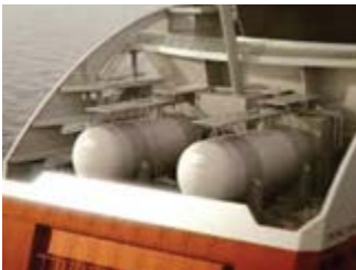
Figure 4 : Installation de réservoirs de type C à bord du Viking Grace
