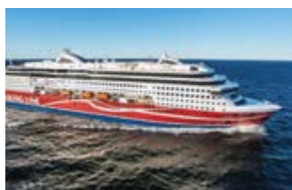
Figure 6 : Le Viking Grace utilise une génératrice à propulsion électrique avec deux moteurs bicarburant
